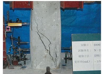
6 せん断破壊試験状況 負側 1/50 第1回目 せん断破壊位置は、注入位置ではなくオリジナルコンクリート。
